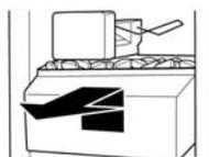
4. Recoloque o recipiente de armazenamento de gelo, empurrando-o bem para dentro. Caso contrário, o distribuidor não funcionará. Empurre a alavanca para baixo até a posição ON para reiniciar a produção de gelo.
